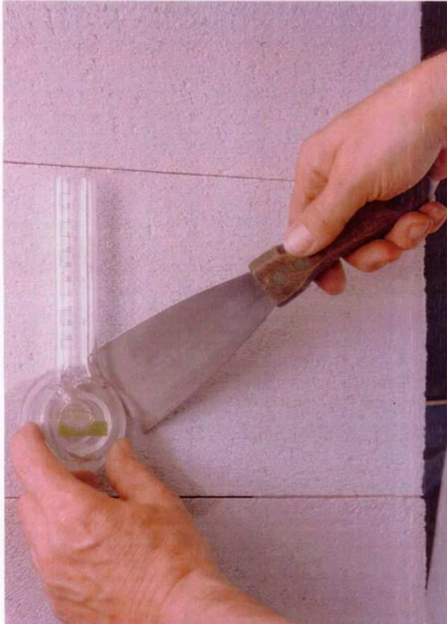
Nach Beendigung der Prüfung ist das Prüfröhrchen vorsichtig mit einem Spachtel vom Untergrund zu entfernen und wie unter 1.) beschrieben zu reinigen.
